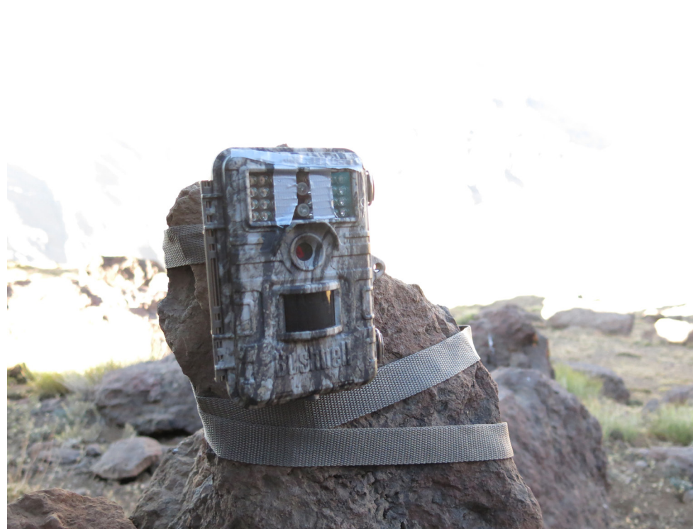
FIGURA 14: Ejemplo de leds tapados en la cámara con cinta adhesiva, evitando sobreexposición de fotografías © Nicolás Lagos.
