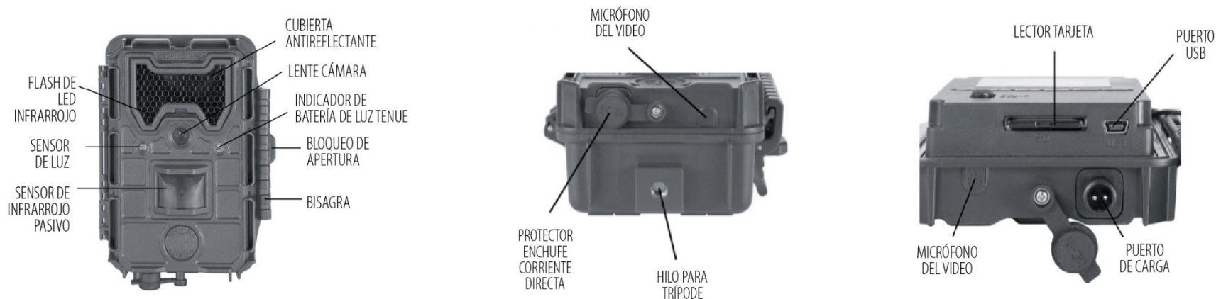
FIGURA 5: Principales componentes de una trampa cámara. © Bushnell Corporation
